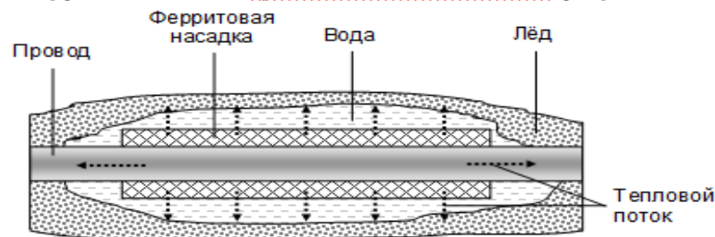
Конструктивная схема противообледенительного устройства
